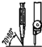
Рис.2. Заточка грифеля в циркуле
